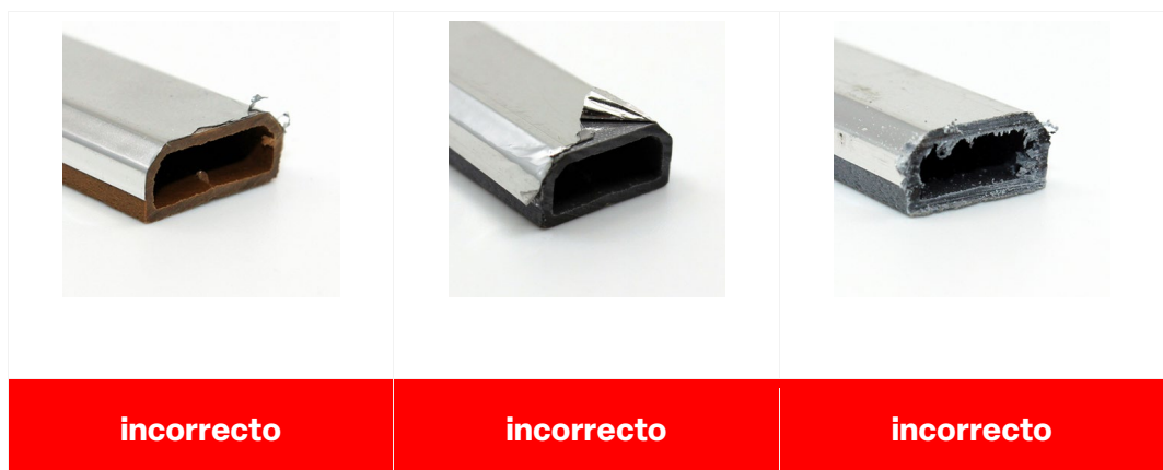
Imagen 8: Ejemplos de cortes seccionales imperfectos
