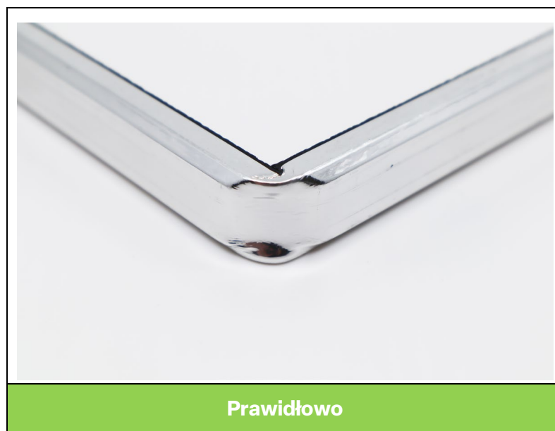
Ilustracja 1: Wygląd folii na ramce dystansowej po zakończeniu procesu gięcia
