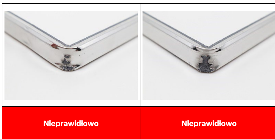
Ilustracja 2: Wygląd folii na ramce dystansowej w przypadku zbyt wysokiej temperatury powietrza
