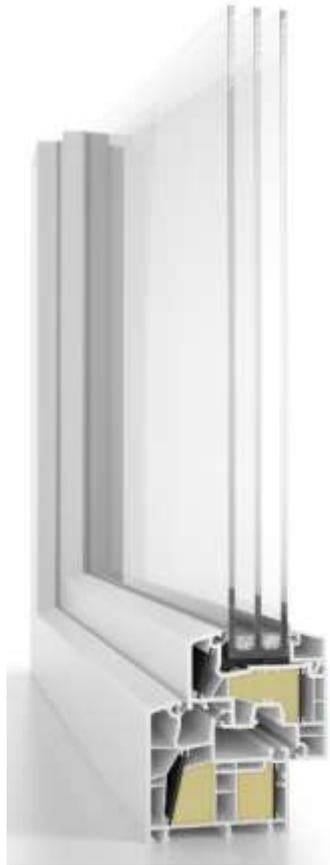
Betrachtet wurde das Fenster hier mit einer 3-fach Verglasung,  $U_g = 0,50 \text{ W}/(\text{m}^2\text{K})$ . Beide Scheibenzwischenräume sind jeweils 18 mm stark, mit Argon gefüllt, und stellen das Optimum des heute mit einer 3-fach Verglasung erreichbaren Wärmeschutzes dar.
