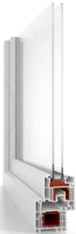
Die Glasrand- $\Psi$ -Werte betragen mit dem Aluminium-Abstandhalter  $0,072 \text{ W}/(\text{mK})$ , mit dem Edelstahl-Abstandhalter  $0,050 \text{ W}/(\text{mK})$  und mit dem Swisspacer Ultimate  $0,033 \text{ W}/(\text{mK})$ . Die Reduzierung der Wärmebrückenverluste durch die besseren Abstandhalter ist deutlich.
